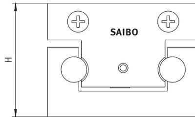
Tolerance H :  $\pm 0.20\text{mm}$
