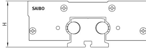
Tolerance H :  $\pm 0.20\text{mm}$
